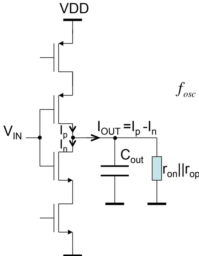
$$t_d \approx \frac{(C_{OUT} + C_{IN})V_{dd}/2}{I_{max}}$$
