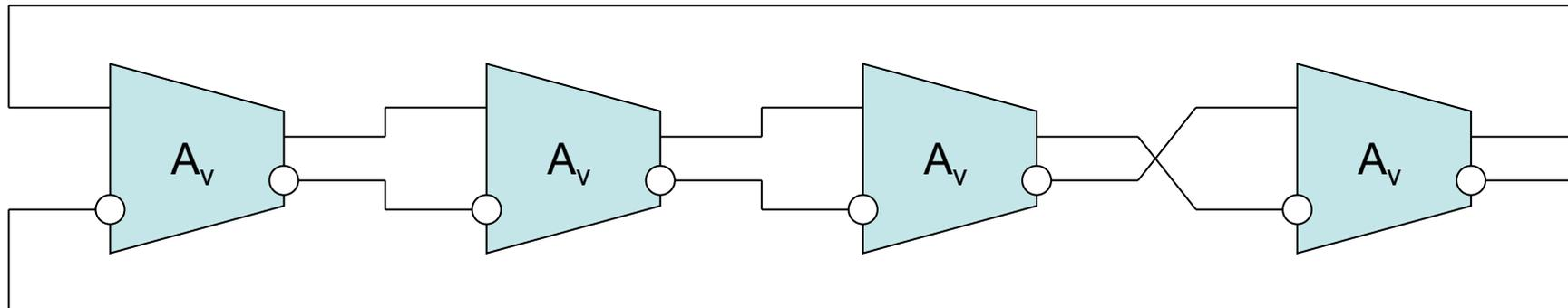
Un autre avantage : nous avons 4 signaux identiques décalés de  $\pi/2$  : parfait pour une application RF où on a besoin de signaux en quadrature...
