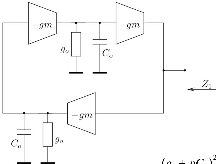
Il ne s'agit donc pas d'un gyrateur « pur », car il y a un dipôle en trop.
