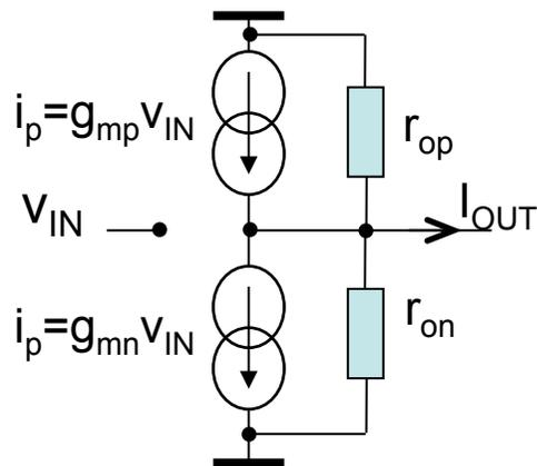
Or, le courant de sortie est limité. Le courant max est à  $V_{IN}=0$ ,  $V_{OUT}=0$ , Mn est bloqué, Mp est passant et saturé
