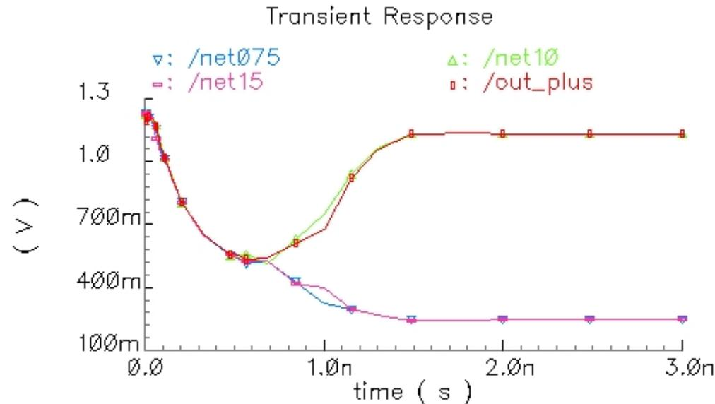
Exemple d'un mauvais réglage du mode commun. Si le gain DC de mode commun est trop grand, nous avons une contre-réaction positive en DC, et le circuit se comporte comme une bascule. Après un transitoire et un temps de métastabilité, le circuit se verrouille dans un état stable « numérique », dans lequel les oscillations en mode différentiel ne sont pas possible.
