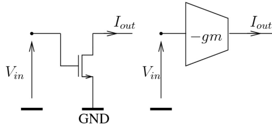
Il faut polariser le transistor: on le fait soit avec une source de courant, soit en ajoutant une transconductance faite à partir du PMOS. On obtient un inverseur MOS, avec transconductance
