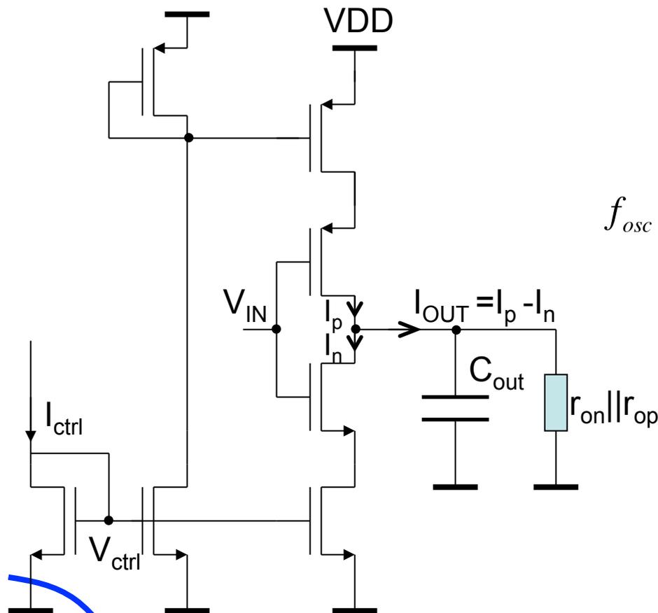
$$t_d \approx \frac{(C_{OUT} + C_{IN})V_{dd}/2}{I_{max}}$$
