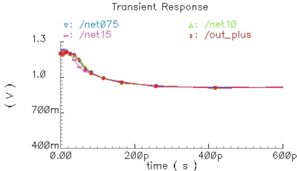
Démarrage normal des oscillations : le circuit démarre en mode commun pur, mais dans une zone où les oscillations ne peuvent pas commencer (les conditions ne sont pas remplies). Ensuite, le mode commun converge vers l'état où les oscillations en mode différentiel peuvent commencer.
