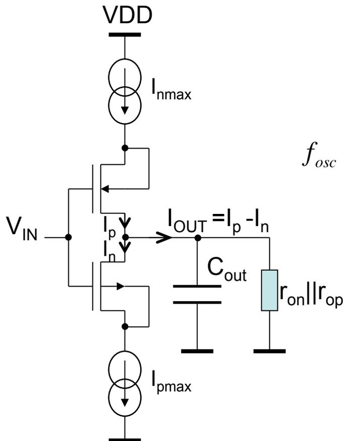
$$t_d \approx \frac{(C_{OUT} + C_{IN})V_{dd}/2}{I_{max}}$$
