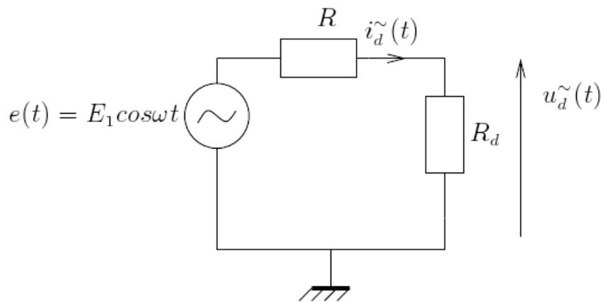
A l'entrée, nous avons donc une tension DC ( $E_0$ ) superposée sur une faible tension sinusoïdale
