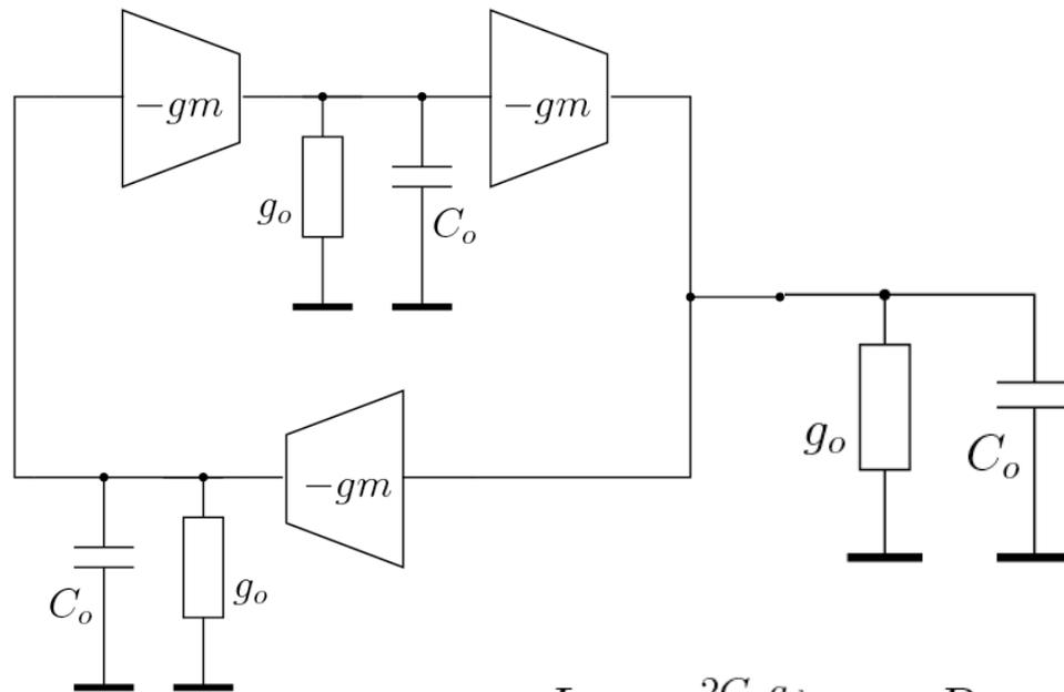
On tient maintenant compte des éléments parasites de la transconductance  $-g_m$ ,  $g_o$  et  $C_o$
