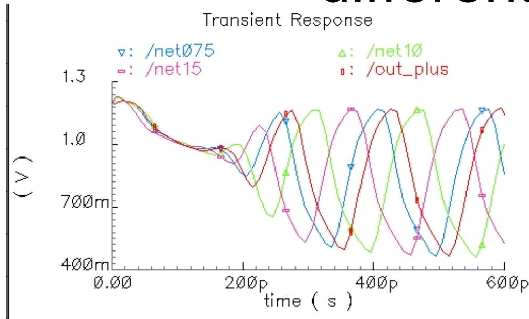
Démarrage normal des oscillations : le circuit démarre en mode commun pur, mais dans une zone où les oscillations ne peuvent pas commencer (les conditions ne sont pas remplies). Ensuite, le mode commun converge vers l'état où les oscillations en mode différentiel peuvent commencer.
