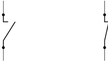
FIG. 3 – Switch à l'état ouvert (circuit ouvert) et fermé (court-circuit).
