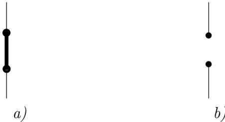
FIG. 2 – Court-circuit (a) et circuit ouvert (b).
