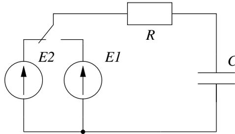
FIG. 2 – Une modification de la tension générée par une source assimilée à une commutation.
