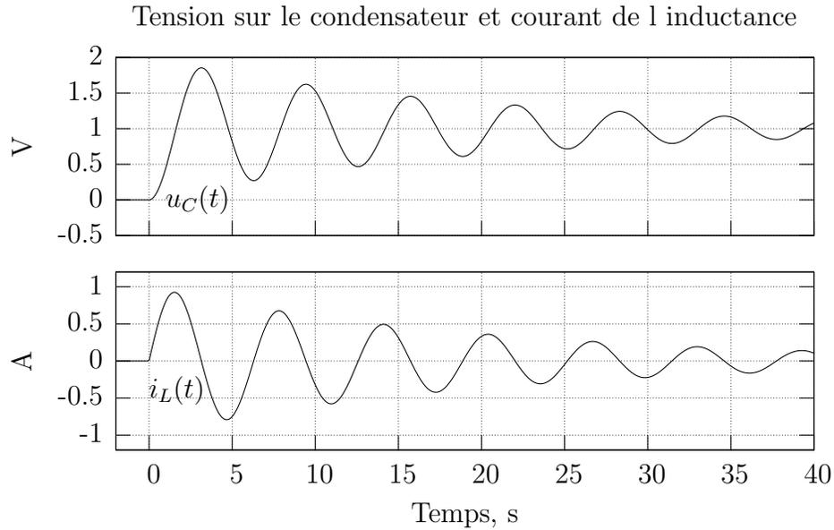
FIG. 6 – Processus transitoire : un réponse oscillatoire. La courbe est obtenue pour les éléments avec les valeurs  $L = 1H$ ,  $C = 1F$ ,  $R = 0.1\Omega$ .
