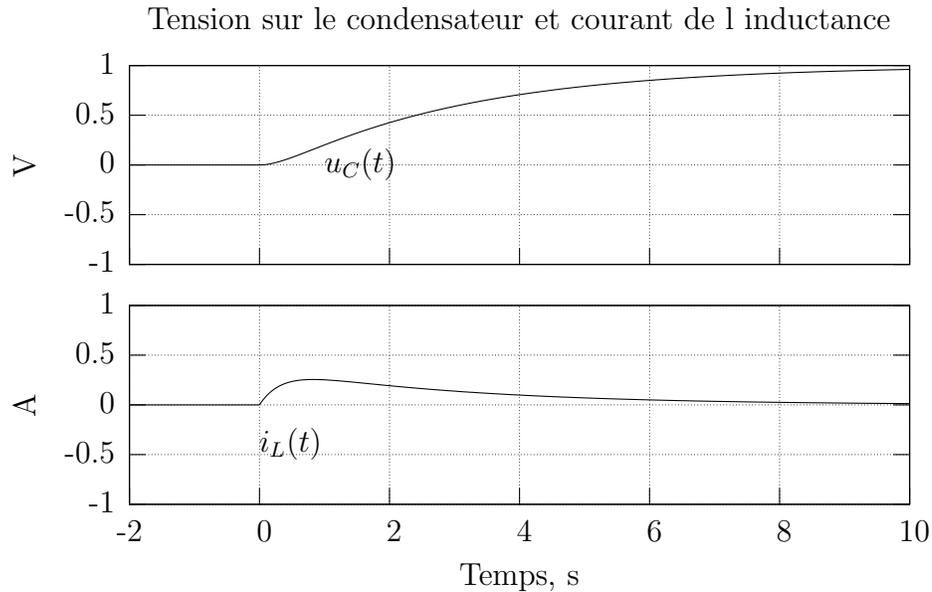
FIG. 8 – Processus transitoire : une réponse exponentielle. La courbe est obtenue pour les éléments avec les valeurs  $L = 1H$ ,  $C = 1F$ ,  $R = 3.3\Omega$ .
