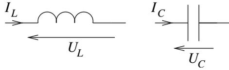
FIG. 1 – Sens positif conventionnel des courants et des tensions dans les éléments réactifs.
