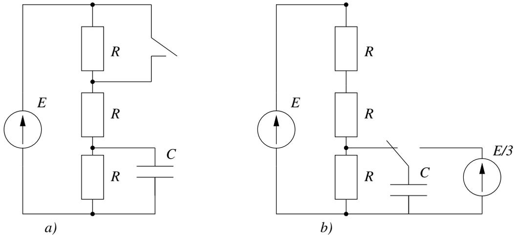
FIG. 3 – a) circuit où un processus transitoire a lieu car la tension sur le condensateur doit passer de  $E/3$  à  $E/2$  lorsque l'interrupteur se ferme, b) circuit où, après que l'interrupteur change sa position, la tension du condensateur reste  $E/3$ , donc il n'y a pas de processus transitoire.
