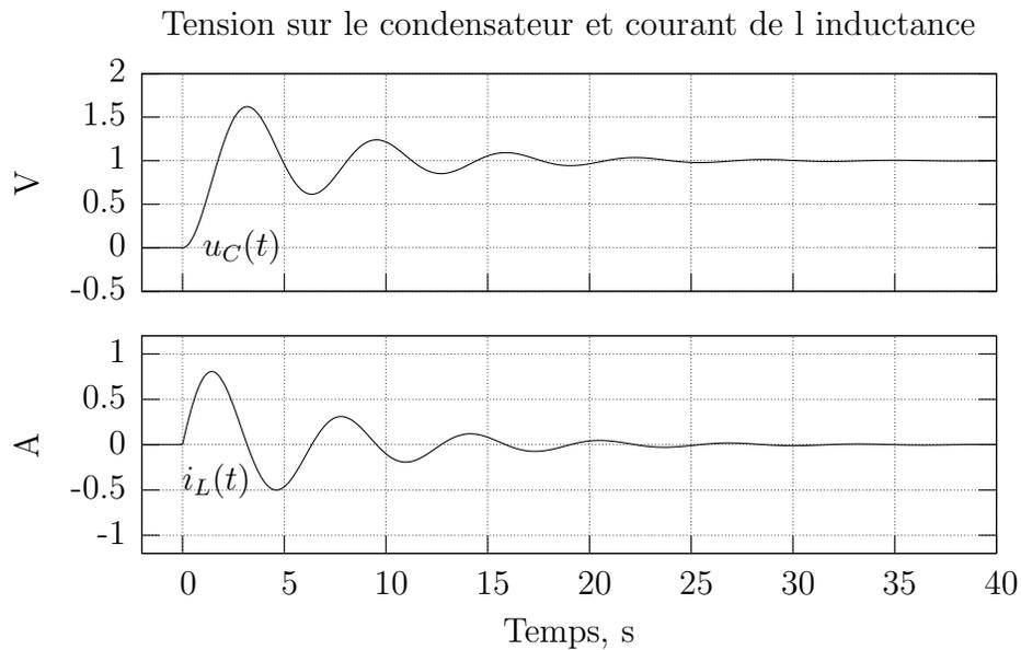
FIG. 7 – Processus transitoire : un réponse oscillatoire. La courbe est obtenue pour les éléments avec les valeurs  $L = 1H$ ,  $C = 1F$ ,  $R = 0.5\Omega$ .
